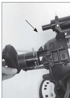
Base y soporte instalados del revés
