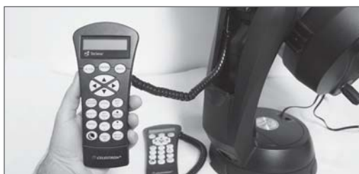
Mando manual NexStar sustituido con mando manual StarSense
