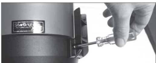
Instale la base con un destornillador Phillips
